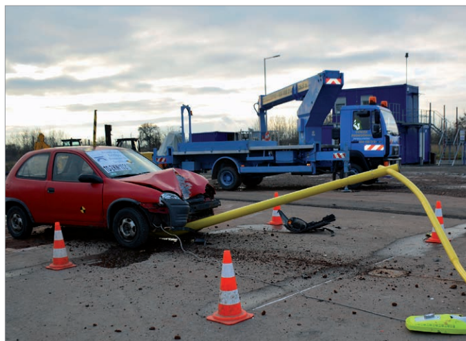
Uderzenie rozpędzonego pojazdu w słup generuje złożone obciążenia mechaniczne w obrębie całej konstrukcji słupa, a szczególnie na odcinku wysięgnika z oprawą oświetleniową
