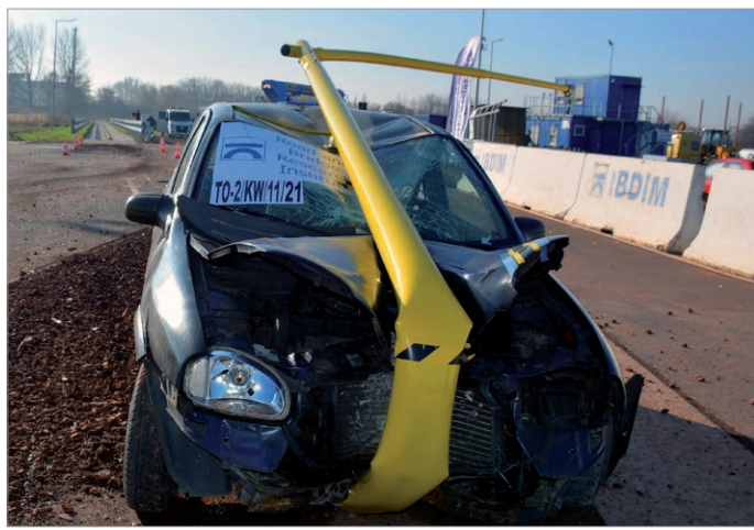
Kluczową sprawą w badaniach, z punktu widzenia oczekiwanych rezultatów prac konstrukcyjnych, była analiza mechanizmu i skali defragmentacji – elementów systemu oświetleniowego, złożonego z trzonu słupa z pokrywą rewizyjną, wysięgnika i oprawy oświetleniowej – powstałej w wyniku uderzenia pojazdu w słup
