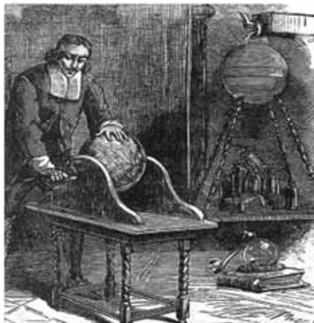
Rys. 7. Otto von Guericke z wymyśloną przez siebie tarciovą maszyną elektrostatyczną (źródło: Wikipedia).
